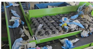
02 絡み合った廃棄物は、スクリーュー軸の回転に接触し解きほぐされ、スクリーュー羽根のピッチより大きい廃棄物は、スクリーュー上を流れる様に水平移動し、コンベア上へ排出される。
